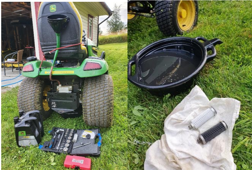
Figur 3 Årsettersyn på John Deere plenetraktor. Skifte av hydraulikkolje på gearboksen. Det kullsorte filteret indikerer at dette skulle vært gjort tidligere.
